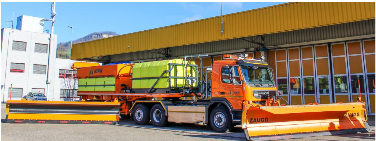
Illustration1 - Charrue latérale sur semi-remorque 1 de la NSNW
