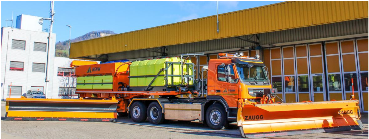
Abbildung 3 - Aufliegerseitenpflug 1 der NSNW
